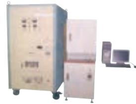
パルス磁化方式。高保磁力磁石を高精度・短時間に測定可能
